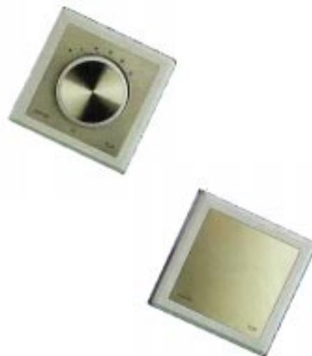
**Réglage caché** : Plusieurs modèles sont fournis avec un bouton de réglage sous le capot. La dépose de celui ci est nécessaire pour modifier le point de consigne, ce qui évite les manipulations par des personnes non autorisées. Les thermostats sont équipés de butées ajustables, incorporées au bouton de réglage, ce qui permet sans tâtonnement de limiter la plage de réglage.
