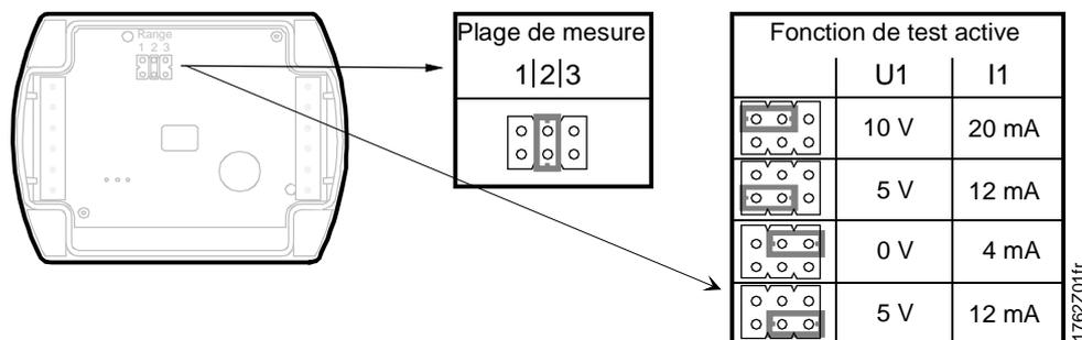
Le dispositif de configuration se trouve dans le couvercle. Il se compose d'un connecteur à 6 broches et d'un cavalier dont le positionnement sur le connecteur permet, soit d'effectuer le choix de la plage de mesure, soit d'activer la fonction de test.
