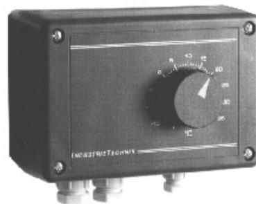
*Les thermostats électroniques à 1 étage de la série I1D sont prévus pour la régulation des températures d'ambiance, de gaine ou d'eau, en fonction de la sonde PTC choisie. Ces thermostats sont équipés d'un boîtier en matière synthétique étanche, avec un niveau de protection IP 65, ce qui leur permet d'être utilisés en milieu industriel ou en extérieur (sonde d'eau = DTLI/NTC, sonde de gaine = DTLA/NTC, sonde d'ambiance = DTB/NTC, sonde extérieure = DTE/NTC).*
